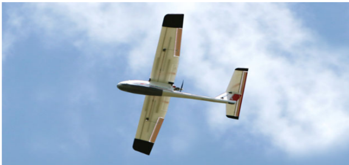
Immagine 3.2 Fotografia di drone ad Ala Fissa. Gli utilizzi di questa tipologia di velivoli variano dalla mappatura geografica di terreni e la loro analisi fino quella dei rilievi in ambito architettonico.
