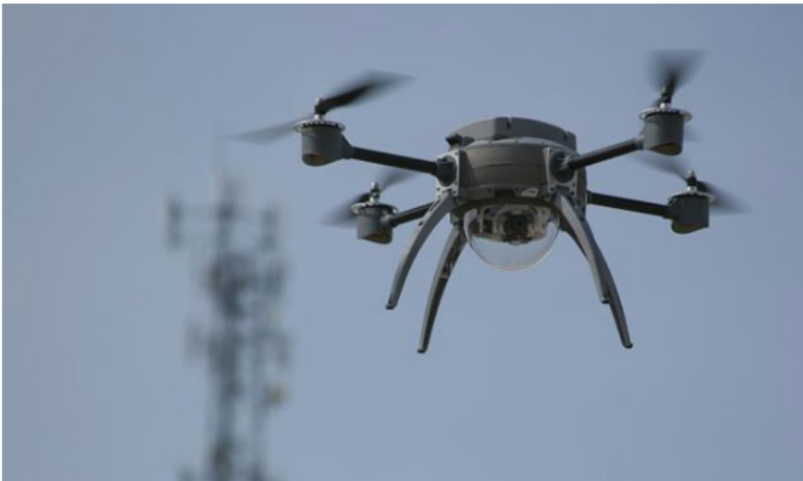
Immagine 3.1 Fotografia di drone quadricottero ad Ala Mobile utilizzato per effettuare registrazioni video. La sua stabilità permette di ottenere registrazioni in aree urbane o extraurbane in sicurezza.
