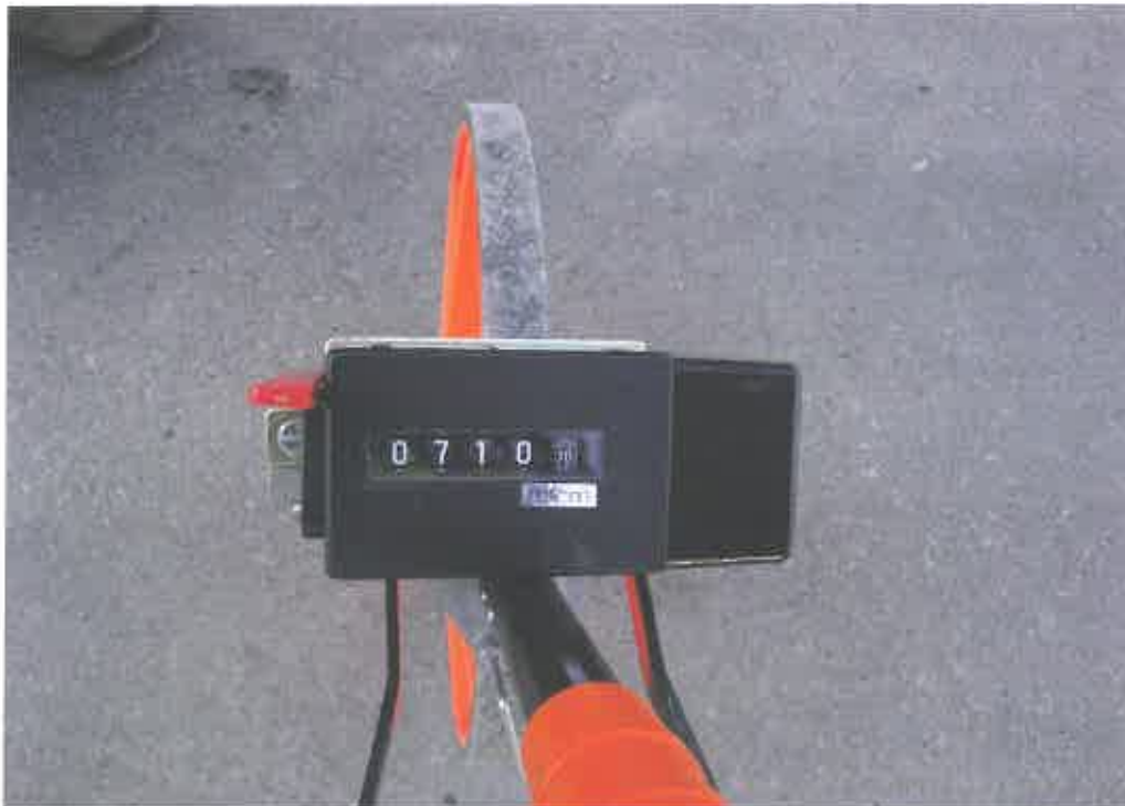
Indicazione sull'odometro della misura raggiunta.
