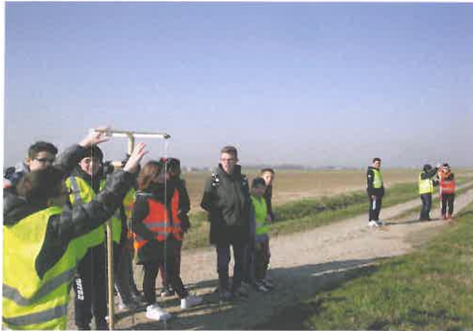
Studenti mentre cercano di fissare la prima palina traguardando i fili a piombo.
